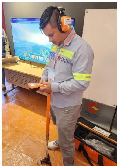
Foto: Detector de fugas, GEOFONO, donado a DEAGUAS.
